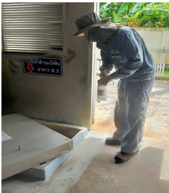
รูปที่ 2 การเก็บตัวอย่างน้ำบาดาลที่ บ่อเก็บน้ำใต้ดินตึก B
