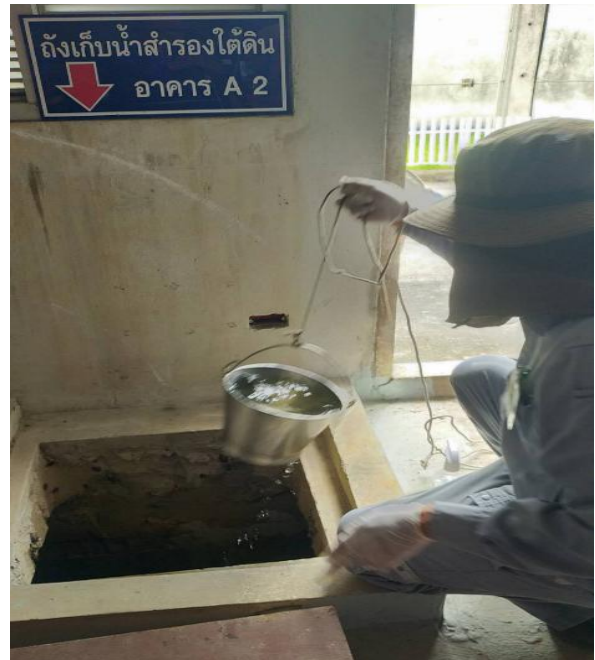
รูปที่ 1 การเก็บตัวอย่างน้ำบาดาลที่ บ่อเก็บน้ำใต้ดินตึก A
